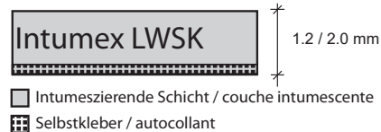
Schichtenaufbau / Structure de couches
